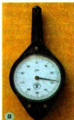
Рис. 37. Курвиметр (а); измерение расстояния с помощью курвиметра (б)
