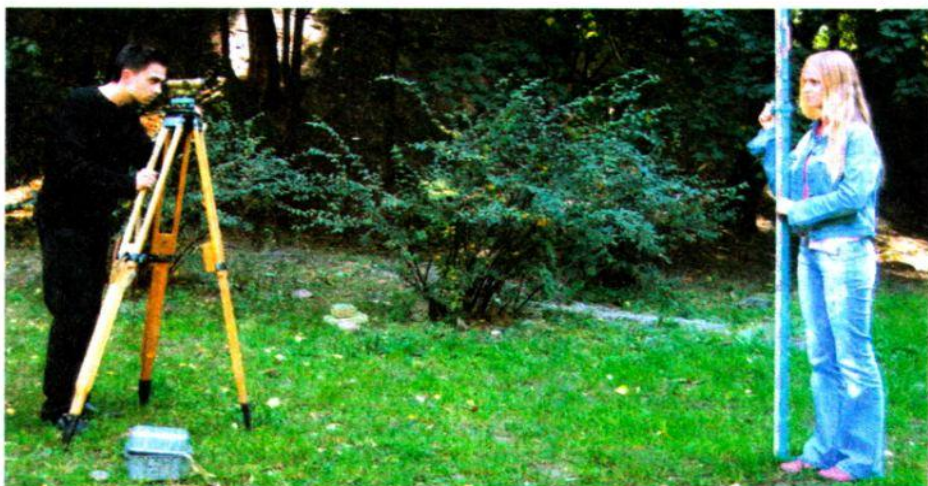
Рис. 46. Нивелирование на местности
